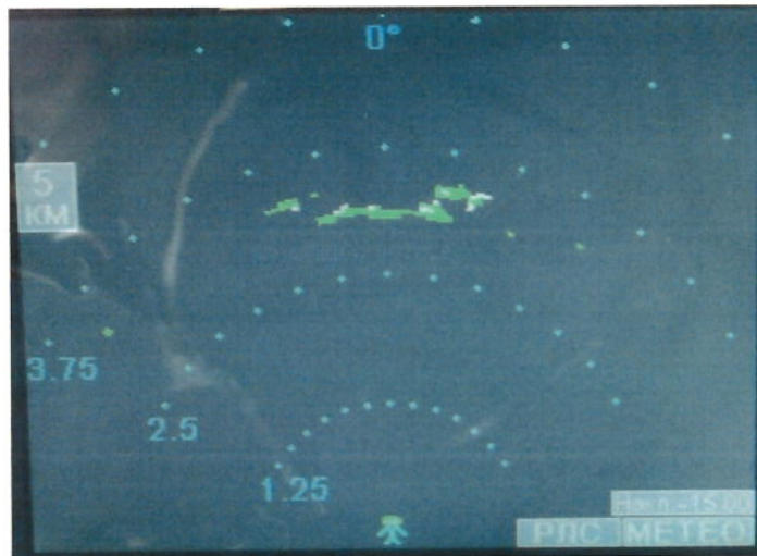
Рисунок 19 – «Кольцо высоты» (высота полета 3 км, наклон минус 15°, режим «Метео»)
