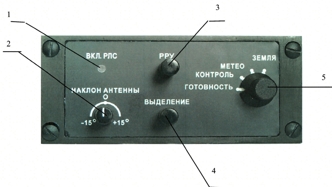
Рисунок 2 - Органы управления пульта управления РЛС
