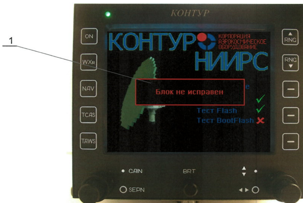
Рисунок 101 - Изображение на экране МФИ в случае обнаружения неисправности при проведении тестирования
