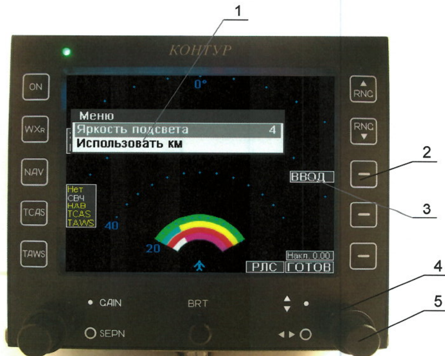
Рисунок 5 – Изображение на экране МФИ при выводе меню настройки яркости подсветки надписей панели и переключения единиц измерения дальности
