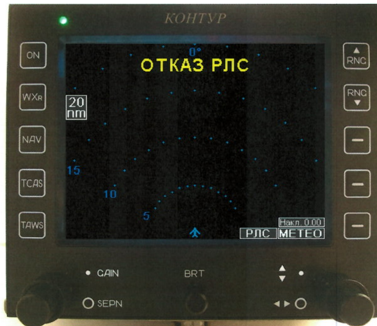
Рисунок 102 - Изображение на экране МФИ при отказе блоков в режиме «Метео».
