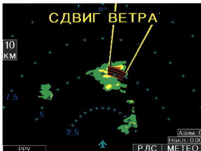
Рис. 12 – Пример перекрытия иконкой сдвига ветра РЛ-информации о метеообразованиях
