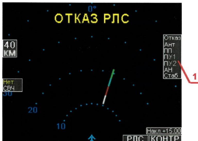
Рис. 2 – Контрольное изображение на экране МФИ при отказах, обнаруженных в режиме «Контроль»
