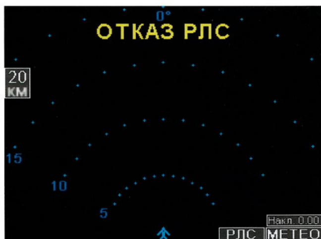
Рис. 1 – Изображение на экране СЭИ при отказе изделия в режиме «Метео»
