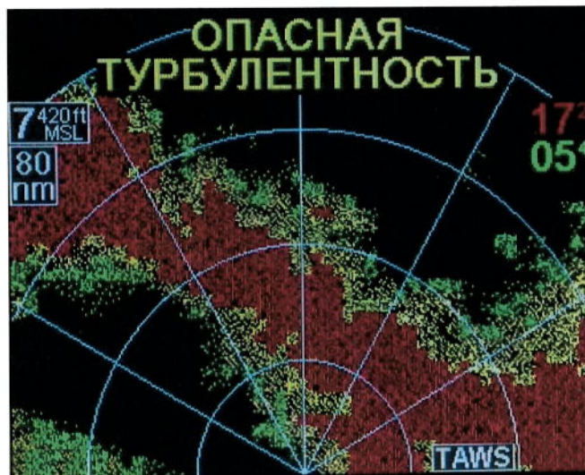
Рис. 9 – Предупреждение от изделия, работающего в дежурном режиме, об обнаружении опасной турбулентности (на экране СЭИ отображается информация от TAWS)
